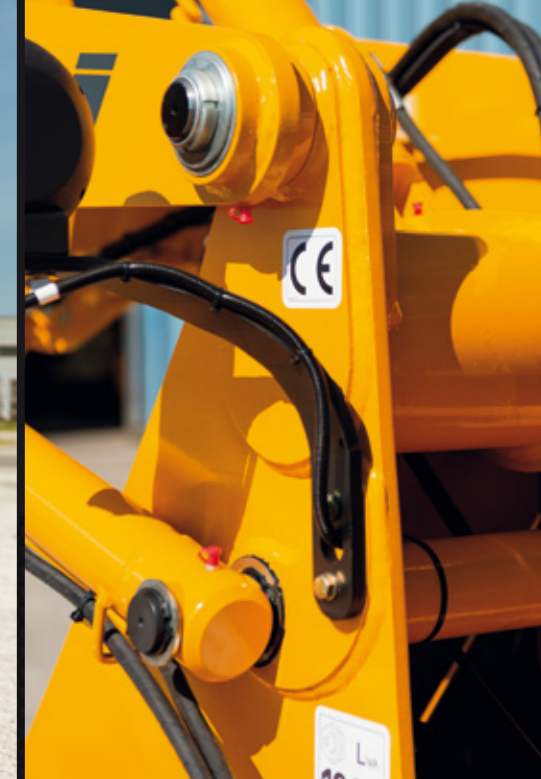
Verbindung Kinematik/Fahrgestell mit Achsbolzen. + Leistung, bessere Sichtweite = reduziertes Risiko!
