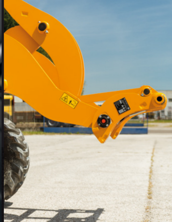
Hydraulischer Schnellwechseleinsatz für Ausrüstungen. Dank dem Schnellwechseleinsatz und den auswechselbaren Ausrüstungen ist Ihre Venieri ein universell einsetzbarer Werkzeugkasten!
