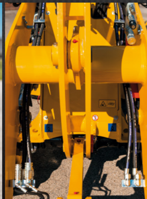
Fortgeschrittene, komplette Hydraulik. Nicht nur High Flow Kit, sondern auch zusätzliche hydraulische Kits für tragbare Ausrüstungen: ein Beispiel? Unser manueller Abbruchhammer!
