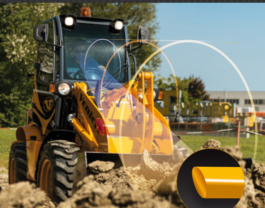
Achsenverbindung mit Eiquerschnitt. Achsenverbindung mit Eiquerschnitt!
